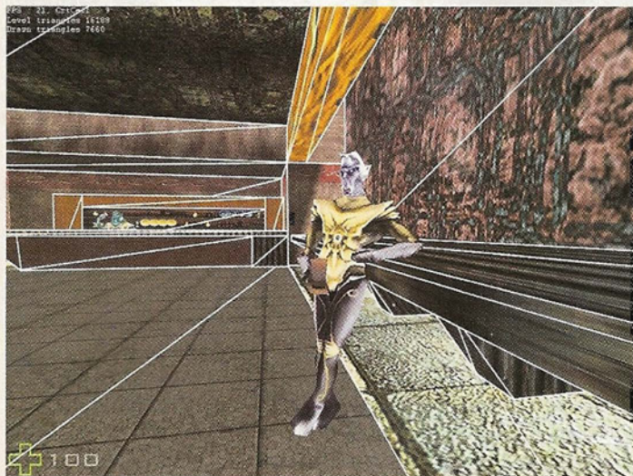
Observați numărul mare de triunghiuri din care este format acest interior simplu.
